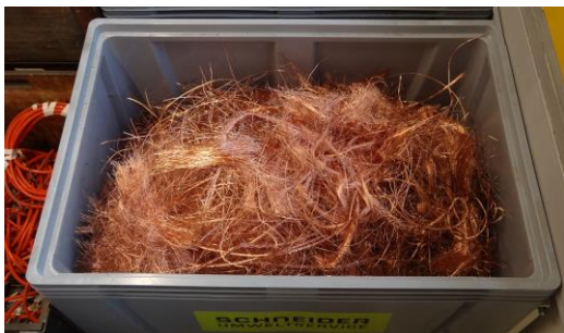
Abbildung 4: wiederverwendbares Kupfer, gewonnen aus Kupferkabelresten
