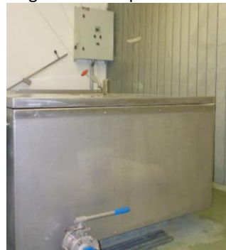
Abbildung 2: neues Laugenbad mit Steuerung
